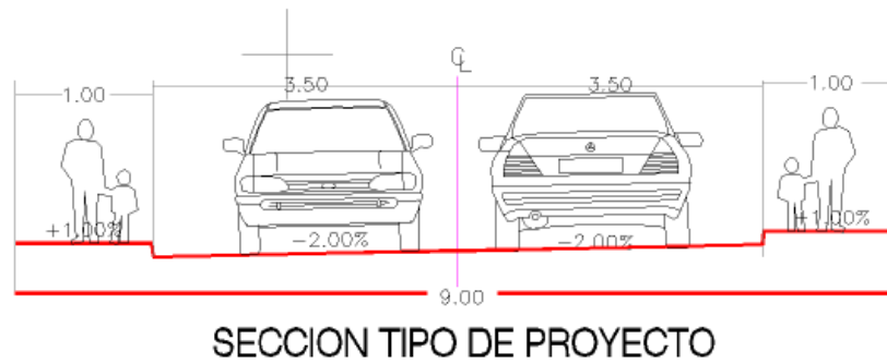
Figura 31. Sección del Boulevard
